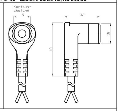
Beschreibung: Anschlusskabel für Temperaturschalter / Temperatursensoren mit Flachsteckanschlüssen 6,3 x 0,8mm.
